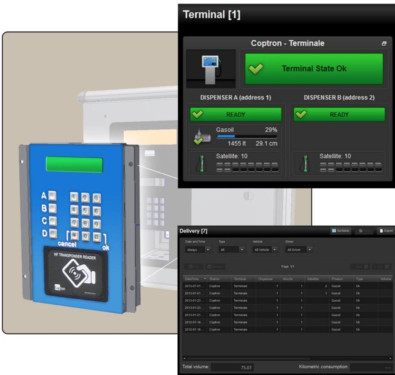
Il software CopterLite Room consente la visualizzazione e la gestione dei dati del sistema di gestione rifornimenti serie AT12.
